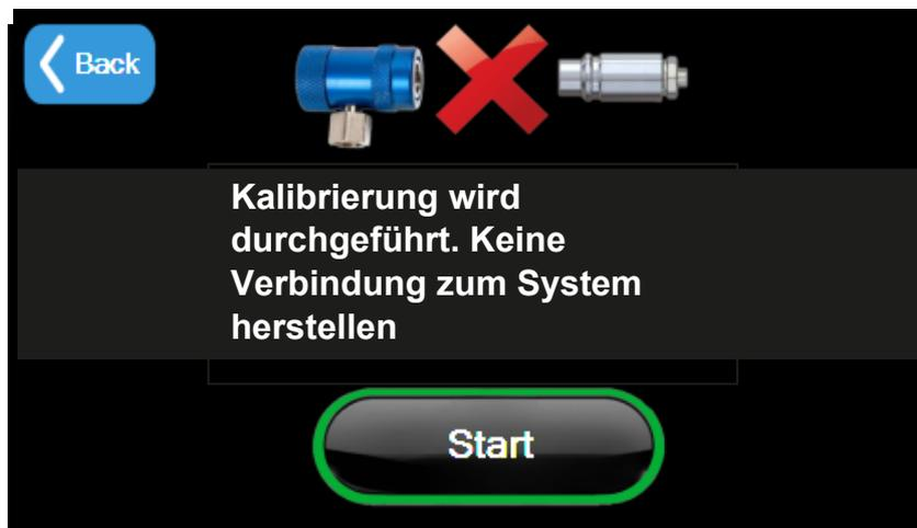
2. Um eine korrekte Kalibrierung zu gewährleisten, schließen Sie den Schlauch während der Kalibrierung NICHT an das System an
