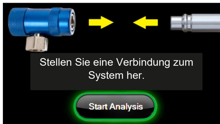
5. Nach der Kalibrierung schließen Sie den Schlauch an das Fahrzeug an und öffnen das Ventil. Drücken Sie die Taste "Analyse starten", um den Analyseprozess zu beginnen.
