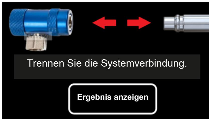
7. Nach dem Abklemmen des Schlauchs können die Ergebnisse durch Drücken der Taste "Ergebnisse anzeigen" auf dem Bildschirm angezeigt werden. Wenn die Reinheit des kalibrierten Kältemittels im Analyseergebnis unter 98,5 % liegt, wird das Ergebnis als negativ bewertet.
