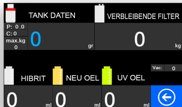
**TANKINFORMATIONEN:** Dieser Abschnitt enthält den Wert der Waage.
